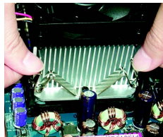
Fig. 1 Attachez l'embase du ventilateur sur le socket du CPU sur la carte mère.
