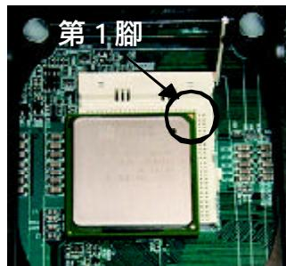
1. 將處理器的第一腳(金色三腳記號處)對準插座上的缺腳記號再將處理器插入插座。
