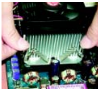
1. Закрепите основание радиатора в разъеме CPU материнской платы.
