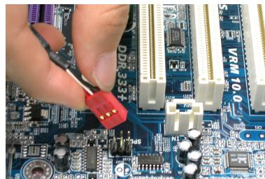
3. Подключите коаксиальный или оптический выход SPDIF к декодеру AC3.
