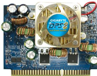
Модуль DPS2 является частью технологии Dual Power System. Схемы питания модуля DPS2 и системной платы совместно образуют шестифазную систему электропитания платы.
