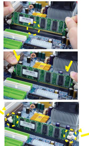
1. Модуль DIMM имеет выемку, которая не позволяет установить его неправильно.
