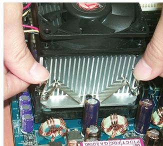
1. Вставьте основание теплоотвода в процессорный разъем системной платы.
