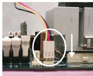
2. Убедитесь, что провод питания вентилятора присоединен к разъему вентилятора на системной плате.
