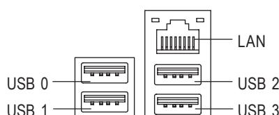
➤ Перед подключением устройства (клавиатуры, мыши, сканера, ZIP-дисковода, колонок и т.п.) к разъёму USB убедитесь, что оно имеет стандартный USB-интерфейс. Убедитесь также, что ваша операционная система поддерживает контроллер USB. Если операционная система не поддерживает контроллер USB, возможно, у ее продавца можно получить новый драйвер или программное дополнение. За более подробной информацией обращайтесь к продавцу операционной системы или подключаемого устройства.
