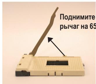
1. До угла в 65 градусов рычаг может подниматься с усилием, после этого продолжайте поднимать его до угла в 90 градусов, пока не услышите щелчок.
