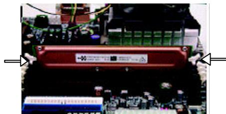
1. 將RIMM模組上金手指上的編號「1」對準插槽上的編號「1」，接著將記憶體模組放入插槽，注意是否對準凹槽。
