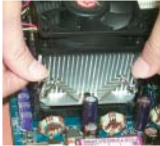
1.Zuerst ein Ende der Kühlerklammer an dem CPU Stecker einhaken.
