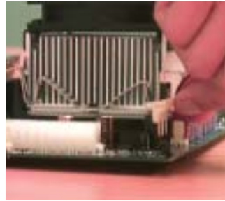
2.Das andere Ende der Kühlerklammer an dem CPU Stecker einhaken.
