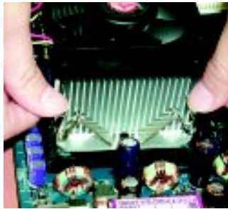
1. Accrochez une extrémité du bras du ventilateur sur le socle du CPU.
