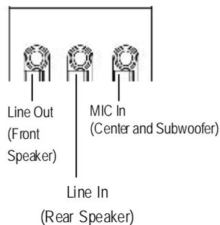
➤ 麥克風接腳可接在麥克風輸入端，至於音源輸入端可以接上如：光碟機，隨身聽及其他音源輸入接腳。
