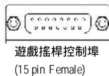
➤ 本主機板支援標準的音效輸入接腳及遊戲搖桿控制埠，您在設定完成內建音效的驅動程式後，即可將喇叭輸出接腳接在音源輸出端。
