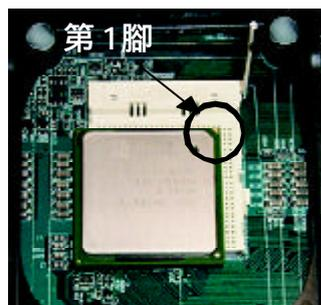
2. 將處理器的第一腳(金色三腳記號處)對準插座上的缺腳記號再將處理器插入插座。
