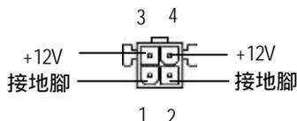
**C) ATX (ATX 電源插座)**
