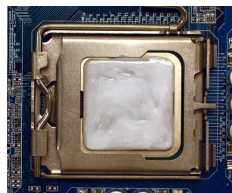
Рис. 1 Нанесите на поверхность процессора равномерный слой термопасты.
