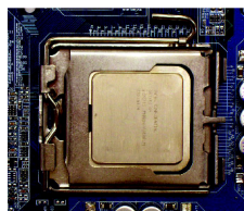
Fig. 4 Una volta che la CPU è inserita bene, rimettere la copertura di plastica e spingere la levetta di metallo nella sua posizione originale.
