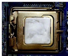
Fig. 1 Étalez une couche de pâte de dissipation thermique sur la surface du processeur une fois installé.
