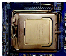
Fig. 4 Une fois que le processeur est installé correctement, remplacez le couvercle en plastique et poussez le levier métallique dans sa position originale.
