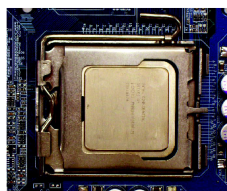
図 3 CPU ソケット端に位置する小さな金色の三角形に注目します。CPU の刻み目のある角を三角形に合わせ、CPU を静かに装着します。(CPU を親指と 4 本の指でしっかりつかみ、直線的な下方動作でソケットに押し込みます。装着時に CPU の損傷を引き起こす可能性のある、ひねりや曲げ動作は避けてください。)
