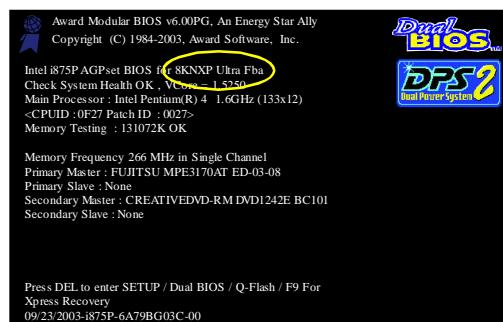
6. 系統開機之後，按Del鍵進入BIOS選單並移動光棒到Load Fail-Safe Defaults選項且按Enter來載入BIOS預設值。在BIOS更新之後，系統在正常情況下會重新去偵測所有週邊裝置；因此，我們建議您在更新完BIOS之後，要重新載入BIOS預設值。
