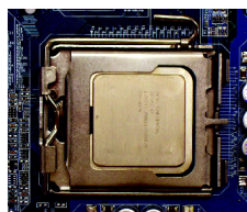
Fig. 3 Tenga en cuenta el pequeño triángulo dorado ubicado en un borde del zócalo de la CPU. Alinee la esquina dentada de la CPU con el triángulo e inserte suavemente la
