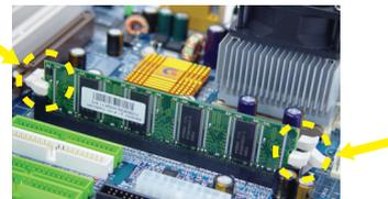
Системная плата GA-8I915G-MF поддерживает технологию двухканальной памяти. В двухканальном режиме пропускная способность шины памяти увеличивается вдвое - до 6,4 Гбайт/с.
