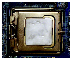
Fig. 1 Applicare uno strato uniforme di colla per dissipatore di calore sulla superficie della CPU installata.
