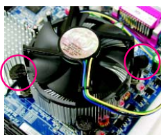
圖 3. 將散熱裝置的插梢對準主機板上的中央處理器腳座孔位，同時將斜對角的插梢用力向下壓。
