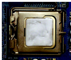
圖 1. 將散熱膏適量塗抹在已安裝完成的中央處理器上。
