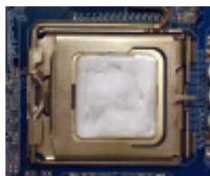
Рис. 1 Нанесите на поверхность процессора равномерный слой термопасты.
