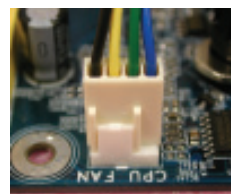
Рис. 6 Подключите штекер провода питания вентилятора теплоотвода к разъему CPU_FAN на системной плате. Установка завершена.
