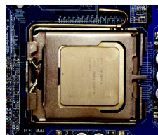
Abb. 4 Nach dem richtigen Installieren der CPU bringen Sie die Ladeabdeckung wieder an und bewegen Sie den Metallhebel zurück in seine Ausgangsstellung.
