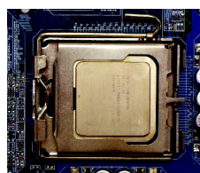
Fig. 4 Une fois que le processeur est installé correctement, remplacez la plaque de chargement et poussez le levier métallique dans sa position originale.
