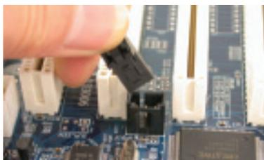
3. Подключите коаксиальный или оптический выход SPDIF к декодеру SPDIF.
