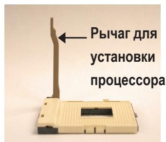
2. Поднимите рычаг до прямого угла (90 градусов).
