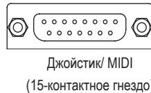
➤ Этот разъём используется для подключения джойстика, MIDI-клавиатуры или другой аналогичной аудиоаппаратуры.
