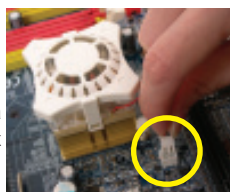
Рис. 2 После установки вентилятора на теплоотводе подключите провод питания вентилятора к разъему NB_FAN на системной плате.
