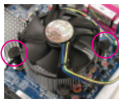
Рис. 3 Разместите теплоотвод на процессоре. Убедитесь, что крепежные штырьки расположены над отверстиями в системной плате. Нажмите на головки штырьков, одновременно поворачивая их в направлении, противоположном стрелке.
