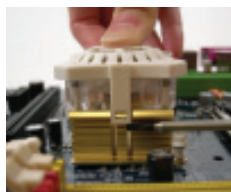
Рис. 3 Перед снятием вентилятора убедитесь, что провод питания вентилятора отключен от разъема на плате. Затем, держа вентилятор за верхнюю часть, с помощью отвертки аккуратно выньте один выступ из выемки.
