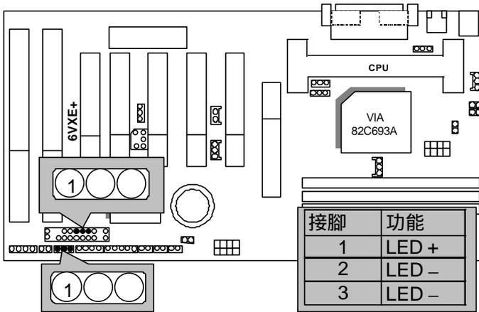
HD : IDE 硬碟指示燈 (IDE Hard Disk Active LED)
