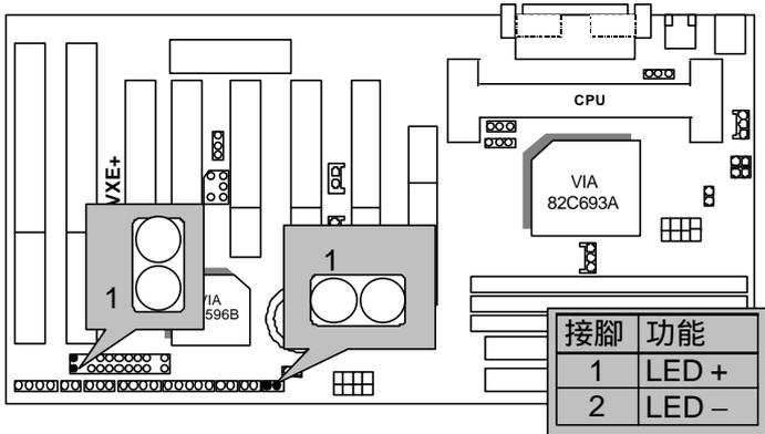
Soft PWR : 系統電源開關接頭 (支援ATX電源供應器)
