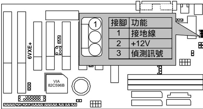
Power FAN :Power 散熱風扇電源接頭
