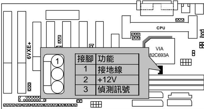
System FAN : System 散熱風扇電源接頭
