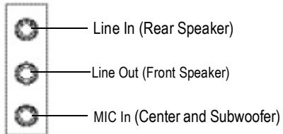
➤ 麥克風接腳可接在麥克風輸入端，至於音源輸入端可以接上如：光碟機，隨身聽及其他音源輸入接腳。您可以藉由音效軟體去選擇使用2/4/6-聲道音效功能，假如你要啟動6-channel功能，請先將音效軟體設妥，以下有2種硬體接法提供你選擇。
