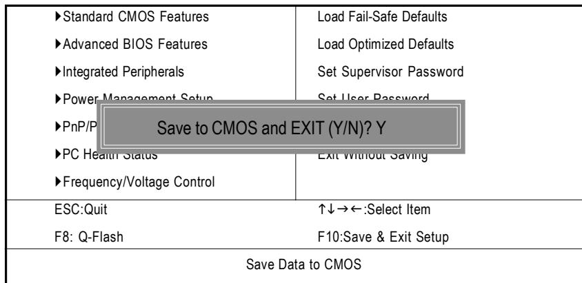
圖 12: 離開 SETUP 並儲存設定結果
