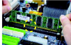
2. 扳開記憶體模組插槽卡榫，以平均施力的方式，將記憶體模組下壓推入插座。記憶體模組插入定位後，將卡榫向內按至卡住。
