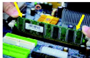
3. 將卡榫向內推，確實卡住記憶體模組 DIMM。一旦固定位置，兩旁的卡榫便自動卡住記憶體模組予以固定。試著輕輕搖動記憶體模組，若不搖晃則裝置成功。
