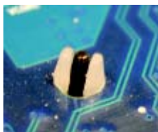
圖 5. 完成安裝時，請檢查主機板背面，插梢腳座如上圖所示，即表示安裝正確。
