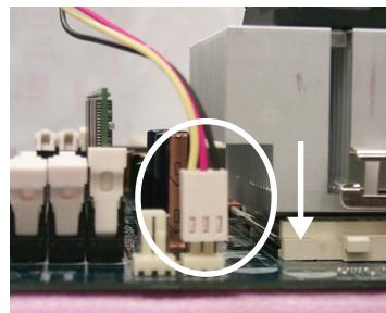
2. Убедитесь, что провод питания вентилятора присоединен к разъему вентилятора на системной плате. Установка завершена.
