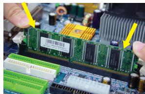
3. Зафиксируйте модуль памяти с обеих сторон пластмассовыми фиксаторами.
