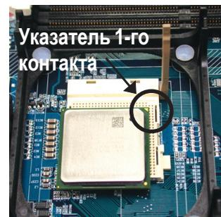
4. Найдите первый контакт в разъёме и срезанный (позолоченный) угол на верхней поверхности процессора. Вставьте процессор в разъём.
