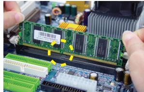
2. Вставьте модуль памяти DIMM в разъём вертикально. Затем надавите, чтобы он вошел в разъем до упора.
