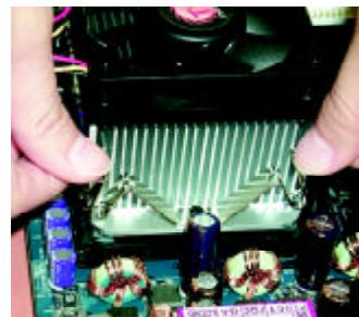
1. 先將 CPU 散熱風扇一邊的卡榫以平均施力的方式往下壓, 直至扣緊為止; 以同樣地 方 式再將另一邊卡榫扣緊.
