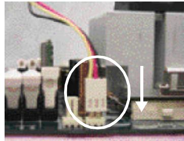
2. 將 CPU 散熱風扇的電源線插入主機板上的 "CPU\_FAN" 插座。
