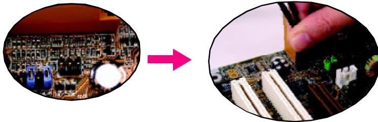
3. 將前置左右聲道插頭連接至音源輸出、後置左右環繞聲道插頭連接至 SURROUND-KIT 的 REAR R/L 輸出及中央 / 重低音聲道插頭連接至 SURROUND-KIT 的 SUB CENTER 輸出。
