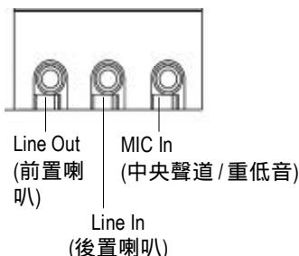
➤ 麥克風接腳可接在麥克風輸入端，至於音源輸入端可以接上如：光碟機，隨身聽及其他音源輸入接腳。
