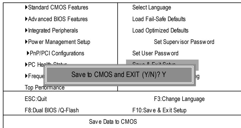
圖 14: 離開 SETUP 並儲存設定結果
