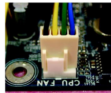
그림 6 끝으로, 방열판의 전원 커넥터를 마더보드에 있는 CPU 팬 헤더에 연결하십시오.
