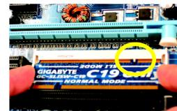
ステップ 3： モジュールの上部エッジをソケットに挿入します。金色のエッジコネクタが完全に挿入されたことを確認します。
