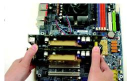
ステップ 2 : SLI ブリッジ(GC-SLICON)を両カード上部の SLI 金色エッジコネクタに挿入します。ブリッジコネクタ上の 2 つの小型スロット(メス)が両カードの SLI 金色エッジコネクタにしっかりと固定されたことを確認します
