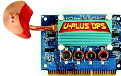
U-Plus DPS はデュアル電源システムで動作できます：パラレルモード。U-Plus DPS およびマザーボード CPU 電源が同時に作動し、合計 8 フェーズの電源回路を提供します。
