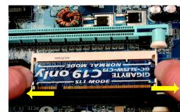
ステップ 2： モジュールの SLI モード側をソケットに対し 25 度角で配置します。モジュールの上部エッジにある小さなノッチをソケットの鍵に揃えます。
