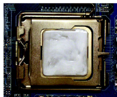
Fig. 1 Por favor aplique una capa uniforme de pasta para disipador en la superficie de la CPU instalada.
