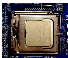
Fig. 3 Tenga en cuenta el pequeño triángulo dorado ubicado en el borde del zócalo de la CPU. Alinee la esquina dentada de la CPU con el triángulo e inserte la CPU en la posición.
