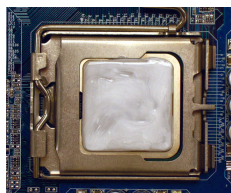
Рис. 1 Нанесите на поверхность процессора равномерный слой термопасты.
