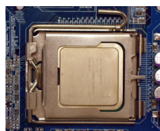
Рис. 4 Убедившись, что процессор установлен правильно, опустите пластмассовую крышку, а затем рычаг крепления процессора.
