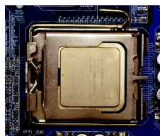
Abb. 4 Nach dem richtigen Installieren der CPU bringen Sie die Plastikabdeckung wieder an und bewegen Sie den Metallhebel zurück in seine Ausgangsstellung.
