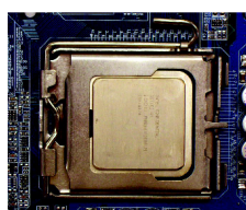
図 3 CPU ソケット端に位置する小さな金色の三角形に注目します。CPU の刻み目のある角を三角形に合わせ、CPU を静かに装着します。(CPU を親指と 4 本の指でしっかりとつかみ、直線的な下方動作でソケットに押し込みます。装着時に CPU の損傷を引き起こす可能性のある、ひねりや曲げ動作は避けてください。)
