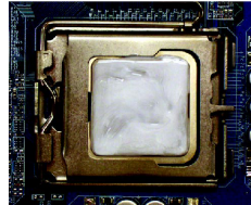
그림 1 설치된 CPU 의 표면에 써멀구리스를 바르 십시오.
