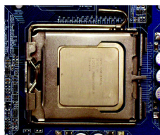
図 3 CPU ソケット端に位置する小さな金色の三角形に注目します。CPU の刻み目のある角を三角形に合わせ、CPU を静かに
