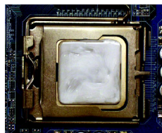
Abb. 1 Tragen Sie eine regelmäßige Schicht von Kühlkörperpaste auf die Oberfläche der installierten CPU auf.
