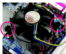
図 3 ヒートシンクをCPUの上にのせ、プッシュピ ンがマザーボード上のピン穴に向いているか 確認します。プッシュピンを斜めに押し下げ ます。
