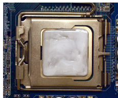
Рис. 1 Нанесите на поверхность процессора равномерный слой термопасты.
