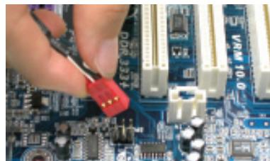
3. Подключите коаксиальный или оптический выход SPDIF к декодеру AC3.
