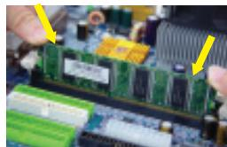
2. Вставьте модуль памяти DIMM в разъем вертикально. Затем надавите, чтобы он вошел в разъем до упора.
