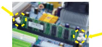
3. Зафиксируйте модуль памяти с обеих сторон пластмассовыми фиксаторами. Для извлечения модуля проделайте эти шаги в обратном порядке.
