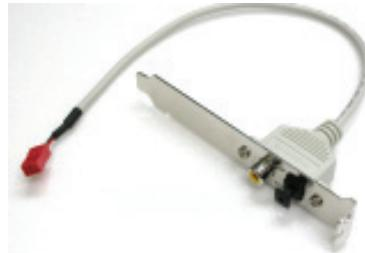
1. Установите планку разъемов SPDIF на заднюю панель компьютера и закрепите ее винтом.
