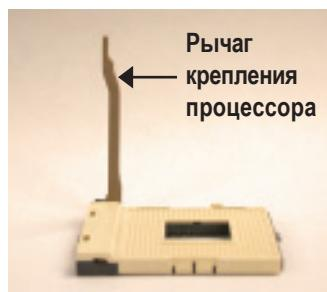
2. Поднимите рычаг в вертикальное положение.
