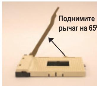
1. До угла в 65 градусов рычаг может подниматься с усилием, после этого продолжайте поднимать его до угла в 90 градусов, пока не услышите щелчок.
