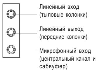
➤ После установки драйвера встроенного аудиоконтроллера к линейному выходу можно подключать колонки, а к микрофонному входу - микрофон. К линейному входу можно подключать, например, выход CD-ROM или переносного аудиоплеера.
