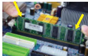
3. Зафиксируйте модуль памяти с обеих сторон пластмассовыми фиксаторами. Для извлечения модуля проделайте эти шаги в обратном порядке.
