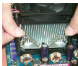
Рис. 2. Вставьте основание теплоотвода в процессорный разъем системной платы.
