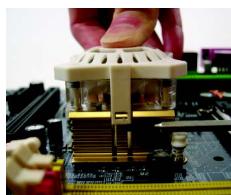
圖 3. 若要拆下 Cool-Plus 時，請先拔除電源線，再將 Cool-Plus 向下壓，以一字螺絲起子將 Cool-Plus 的扣環向外扳開即可。
