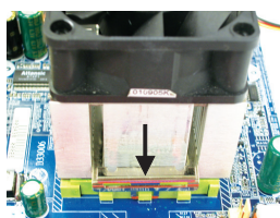
Рис. 2. Вставьте основание теплоотвода в процессорный разъем системной платы.
