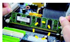
1. DIMM モジュールはDIMM ソケットのノッチにより一方向にしか差せないようになっています。
