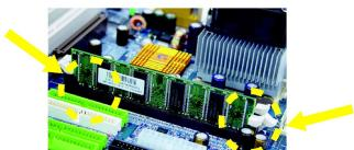
3. DIMM ソケットの両側にあるプラスチックのクリップを閉じて、DIMM モジュールを固定します。
