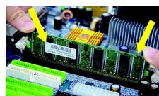
2. DIMM メモリは、DIMM ソケットに真っ直ぐ差します。そして下方に押します。
