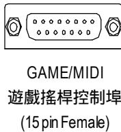
➤本主機板支援標準的音效輸入接腳及遊戲搖桿控制埠，您在設定完成內建音效的驅動程式後，即可將喇叭輸出接腳接在音源輸出端。
