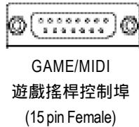
➤ 本主機板支援標準的音效輸入接腳及遊戲搖桿控制埠，您在設定完成內建音效的驅動程式後，即可將喇叭輸出接腳接在音源輸出端。
