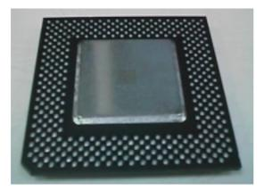
Figure 1: INTEL<sup>®</sup> Celeron<sup>™</sup> Socket370 Processor
