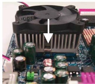
3. 先将 CPU 散热风扇一边的卡榫以平均施力的方式往下压，直至扣紧为止；以同样方式再将另一边卡榫扣紧。
